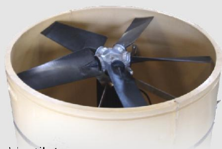
Ventilator. Alle motorer er GRUNDFOS. Alle vinger er MULTI-WING
